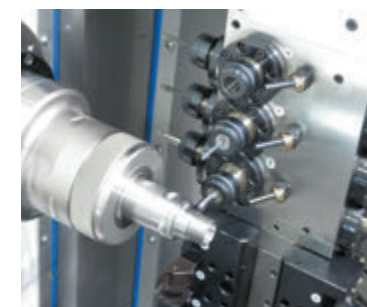
Фрезерная обработка на главном шпинделе
