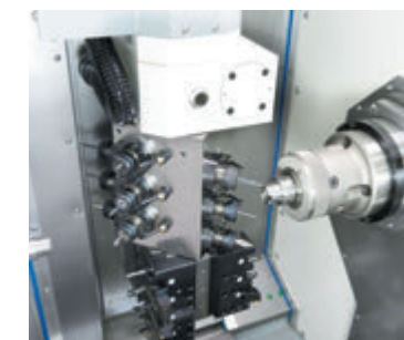
Фрезерная обработка на противопинделе с применением оси В
