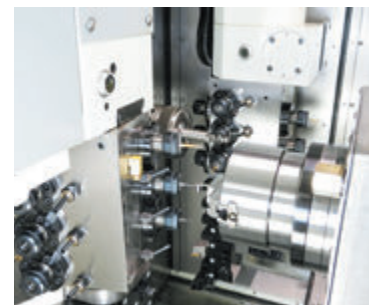
Фрезерная обработка детали в протившпинделе
