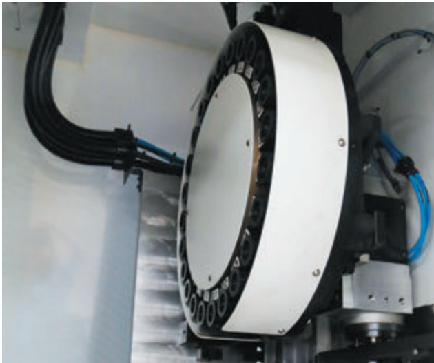
Система смены инструмента барабан + рука-манипулятор
