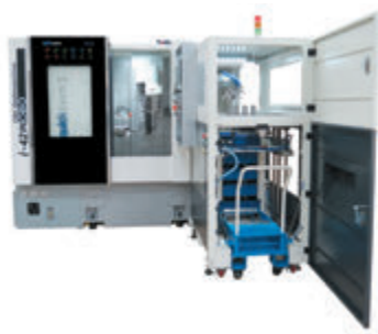
Станок с накопителем заготовок и готовых деталей
