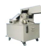
Бак СОЖ с магнитным сепаратором
