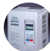
Инвертор привода шлифовального шпинделя
