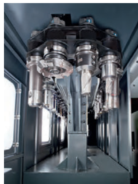
■ Каждая точка смены инструмента и движения имеет свой сенсор для гарантии нормального функционирования в течение смены инструмента. ■ Стандартное количество: 32 поз.; 60 поз./ 90 поз./ 120 поз. ( Опц. ).
