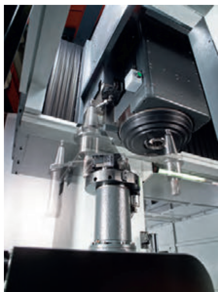
■ Каждая точка смены инструмента и движения имеет свой сенсор для гарантии нормального функционирования в течение смены инструмента. ■ Стандартное количество: 32 поз.; 60 поз./ 90 поз./ 120 поз. ( Опц. ).
