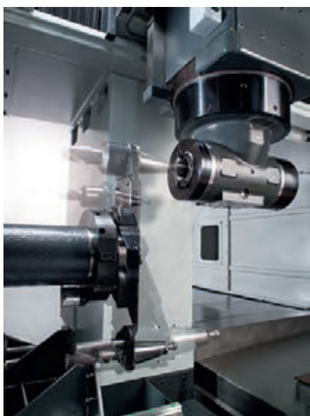
■ Каждая точка смены инструмента и движения имеет свой сенсор для гарантии нормального функционирования в течение смены инструмента. ■ Стандартное количество: 32 поз.; 60 поз./ 90 поз./ 120 поз. ( Опц. ).
