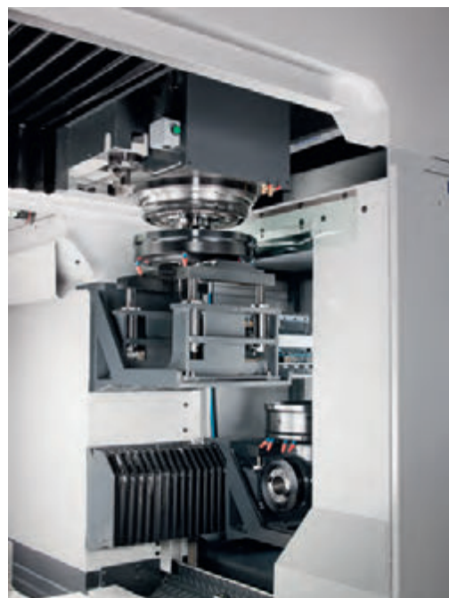
■ Автоматический накопитель головок состоит из двух независимых мест хранения с направляющими качения, что обеспечивает возможность быстрой смены. Каждое хранилище оборудовано независимой дверью, которая открывается только тогда, когда происходит смена головки, чтобы предотвращать попадание стружки внутрь.
