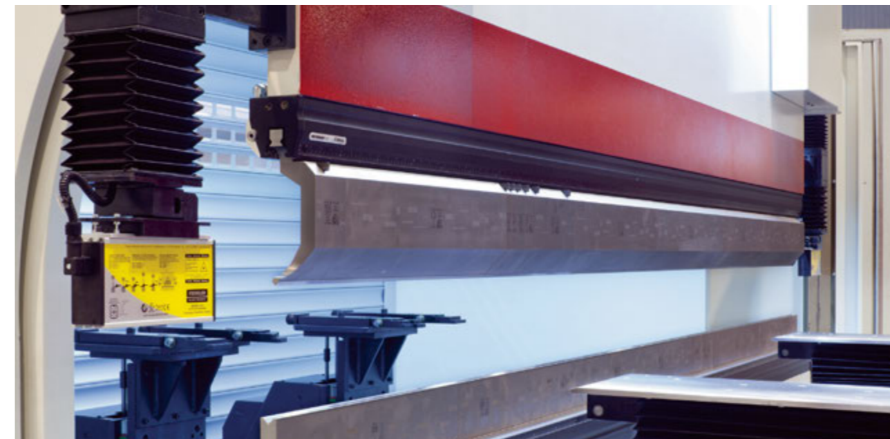
Вид инструментального крепления Wila и лазерной защиты
