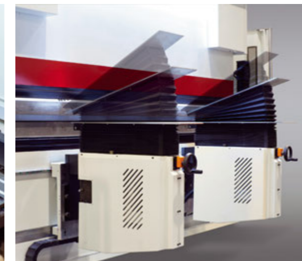
Приводная передняя подача заготовки на прессе
